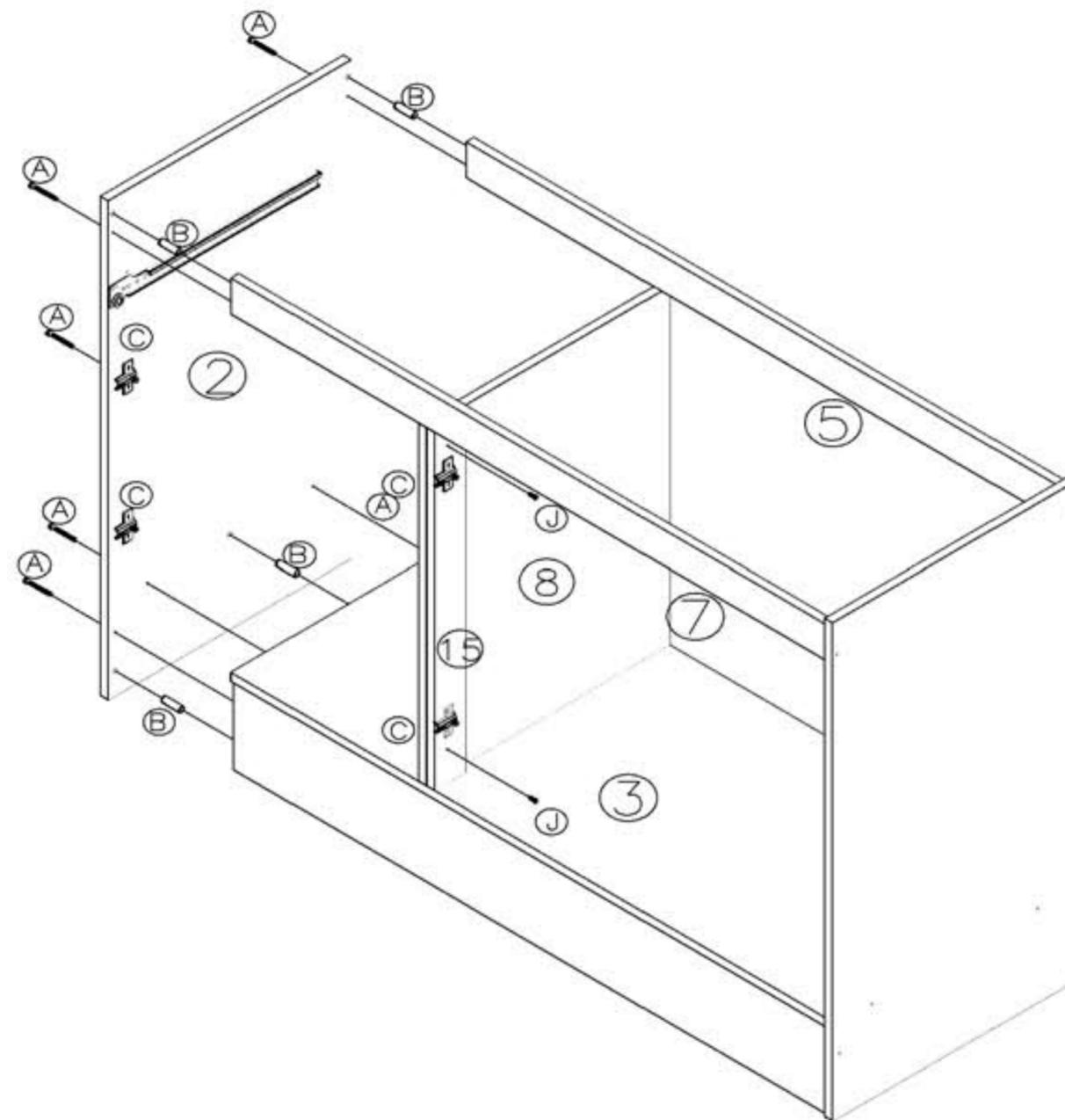
**NOTA:** ESTE MUEBLE ESTA DISEÑADO PARA SER INSTALADO CON EL CAJÓN A LA DERECHA O IZQUIERDA DEPENDIENDO DE LA FORMA EN LA QUE SEA ARMADO. AL VENIR ESTE MUEBLE CON LAVAPLATOS CON LLAVE Y DESAGUE (M) CON SECADOR IZQUIERDO SE DEBE COLOCAR EL COSTADO INTERNO ⑧ EN EL LADO IZQUIERDO PARA QUE EL CAJÓN COINCIDA ABAJO DEL SECADOR. AL MOMENTO DE FIJAR LAS PIEZAS PISO ③ Y BARRAS ⑤ ⑦ ASEGURARSE QUE PERFORACIONES PARA COSTADO INTERNO ⑧ QUEDEN HACIA EL LADO IZQUIERDO.
