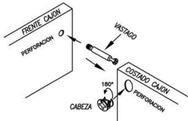
1° INSERTE CABEZA EN PERFORACIÓN HECHA EN EL COSTADO DE CAJÓN, DEJANDO EL TRIÁNGULO (DIBUJADO EN LA PIEZA) MIRANDO HACIA LA PERFORACION DEL CANTO. 2° INSERTAR VÁSTAGO A PERFORACIÓN DEL FRENTE DE CAJÓN HASTA QUE TOPE CON LA CABEZA. 3° ROTAR CON ATORNILLADOR EN 180 GRADOS LA CABEZA DEL MINIFIX, AJUSTANDO ASÍ EL MECANISMO.
