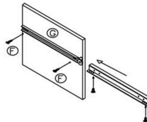
1° UBIQUE PARTE "A" DEL RIEL CON FORMA DE U FRENTE A LOS PUNTOS DE GUÍA EN LOS COSTADOS O DIVISORES Y FIJELOS FIRMEMENTE UTILIZANDO SPAX (F). 2° SITUE LA OTRA PARTE DEL RIEL (CONFORMA DE Z) EN EL CANTO DEL COSTADO DE CAJÓN Y FIJELO FIRMEMENTE CON SPAX (F).
